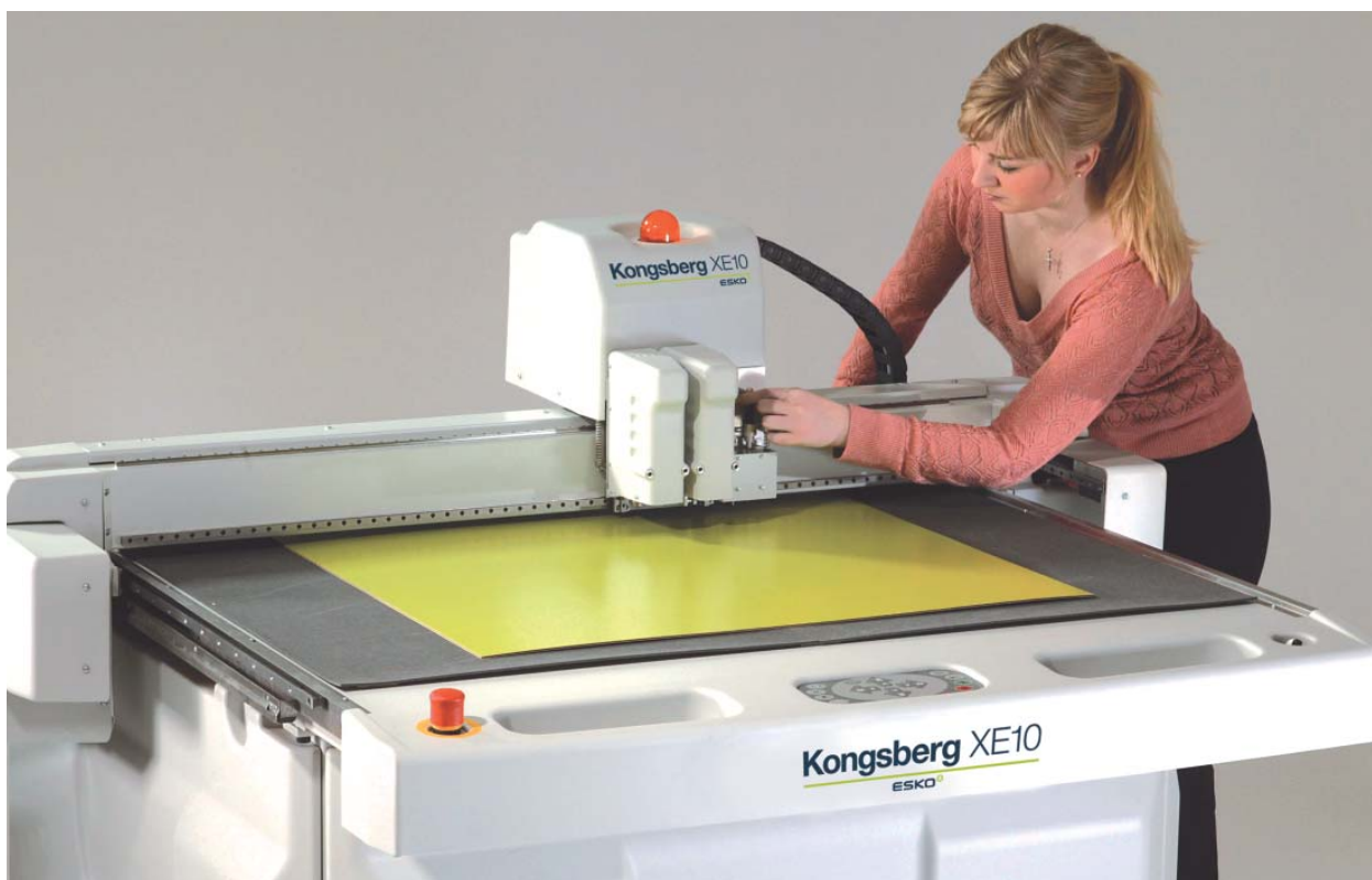
Промышленный плоттер Kongsberg XE10 формата B0 для обработки упаковочного картона и микрогофрокартона. Основные достоинства: высокая производительность, быстрая переналадка, прецизионная точность резки, биговки, черчения.
