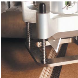
Биговальный диск легко заменяется на нож V-notch для выполнения косого реза в семислойном гофрокартоне.
